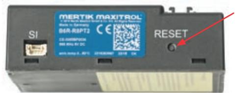
Jetzt haben Sie 11 Sekunden, um an der Fernbedienung auf die Taste „Pfeil nach unten“ zu drücken. Die Taste gedrückt halten, bis zwei kurze Pieptöne vom Empfänger zu hören sind. An der Fernbedienung ist das Wort „conn“ zu sehen. Wenn die Fernbedienung zu blinken aufhört, sind Fernbedienung und Empfänger synchronisiert.
