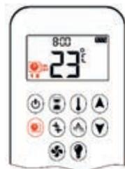
**Hinweis!** Die eingestellte Temperatur für den Thermostatmodus ist die Temperatur für die Betriebszeit im Programmmodus. Wenn die eingestellte Zeit für den Thermostatmodus geändert wird, ändert sich auch die Temperatur für die Betriebszeit im Programmmodus.
