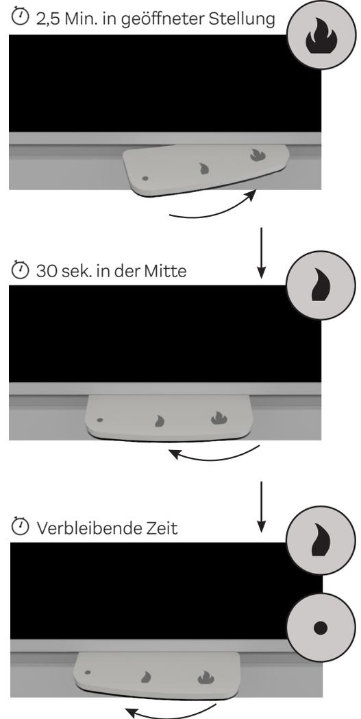
Der Dämpfer wird dann zwischen der Mittelstellung und der geschlossenen Stellung\* eingestellt.
