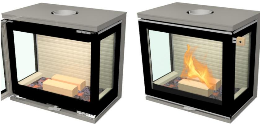
Es ist wichtig, dass die beiden Brikettstäbchen mittig und entsprechend der Anleitung in den Kaminofen gelegt werden. Das erste Stäbchen wird 6-7 cm von der Rückenplatte entfernt platziert, während das nächste Stäbchen 2-3 cm vor dem ersten Stäbchen platziert wird.
