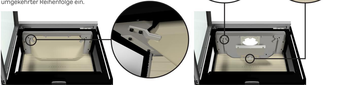
Die Rauchwendeplatte entfernen, indem man die Front nach oben schiebt und nach vorne zieht, sodass sich die Hinterseite aus den senkrechten Platten löst.
