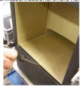
3. Anschliessend entnehmen Sie die Seitenplatte.
