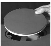
Setzen Sie die Verschlussplatte und die Dichtung in die Öffnung an der Oberseite ein. Achten Sie dabei auf korrekten Sitz der Dichtung. Schrauben Sie alle Teile mithilfe der drei M6 Muttern fest.
