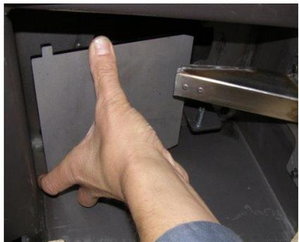
Entfernen Sie Staub und Schmutz und setzen Sie die Teile in umgekehrter Reihenfolge wieder ein.
