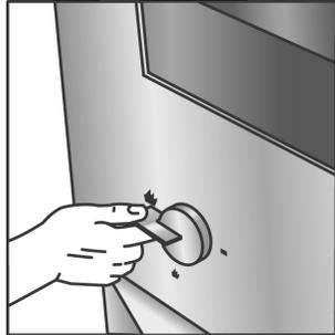
— = **Position Luftzufuhr aus**. In dieser Position ist Primär- und Sekundärluftzufuhr **geschlossen**. Schieber in diese Position bringen, wenn nicht gefeuert wird.
